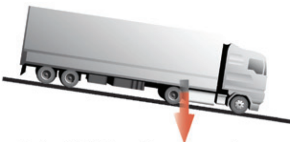
Σχήμα 2.27. Δύναμη βάρους σε κατωφέρεια
