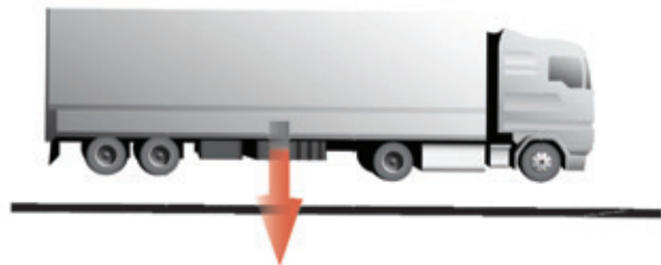
Σχήμα 2.25. Δύναμη βάρους σε επίπεδη επιφάνεια
