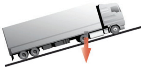
Σχήμα 2.26. Δύναμη βάρους σε ανωφέρεια
